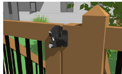
Exemple de loquet permettant à la porte de se verrouiller automatiquement. La porte devrait aussi être munie de pentures à ressort afin de se refermer automatiquement.
